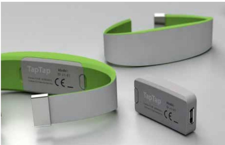
браслет имеет размеры 49×18×12 мм и массу 30 г, регулируется для разного размера запястья и содержит в себе акселерометр, небольшую сенсорную поверхность, вибромотор и аккумулятор на 80 мА·ч, подзаряжаемый от microUSB. От зарядки до зарядки браслет будет «жить» не менее недели.
