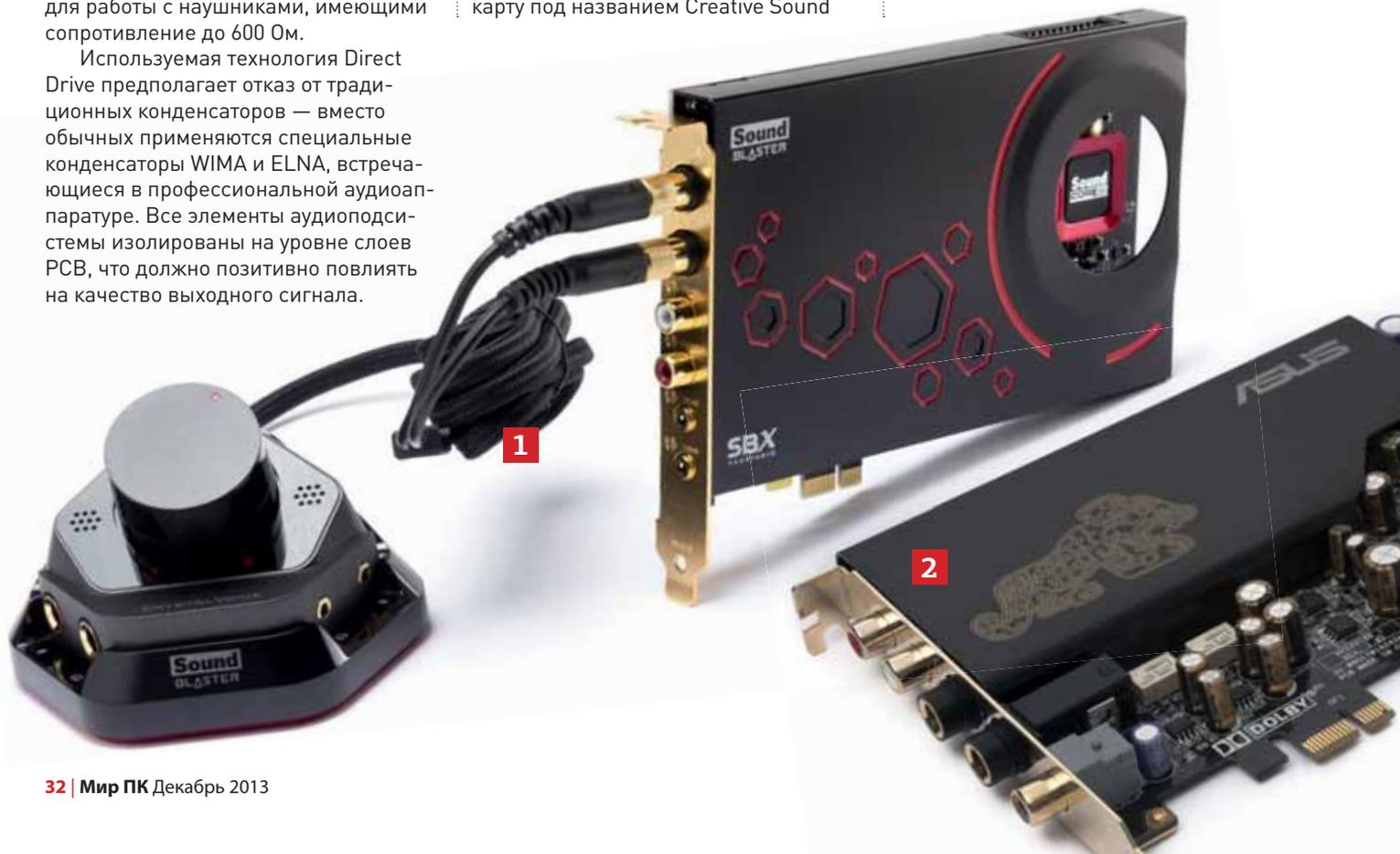
По сути, эта звуковая карта позиционируется для профессиональных пользователей: для микрофона и наушников установлены 6,3-мм разъемы, а также есть RCA-выходы стерео для подключения усилителя, ресивера или просто пары активных мониторов. Завершают набор интерфейсов два 3,5-мм гнезда для центральной колонки и тыловых сателлитов в системе 5.1.
